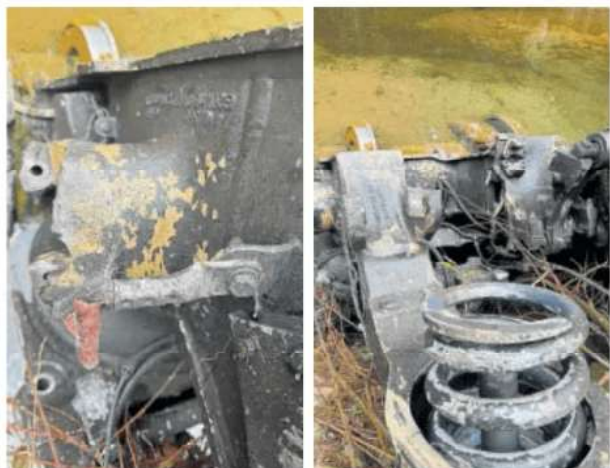
Diversas partes del bogie del coche número ocho del Iryo, ayer en un arroyo próximo al lugar del siniestro. I. D.
